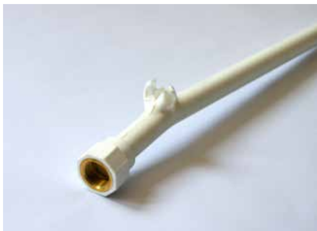
Slika br. 64: Primer pucanja cevi od čistog PP-R materijala
