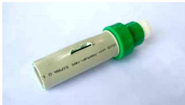
Slika br. 65: Primer pucanja PP-R-FG cevi
