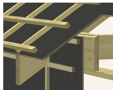
Overgang vegg/tak med sperreutstikk
